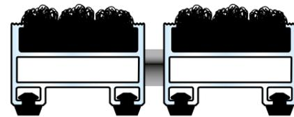
Cette isolation phonique bien supérieure à la moyenne repose sur des bandes de caoutchouc insérées dans le profilé en sous face. Cette solution technique en sous face assure une isolation phonique parfaite tout en favorisant l'écoulement de l'eau sous le tapis. Notre gamme PREMIUM comprend les modèles Top Clean TREND®, STABIL, OBJEKT et GREEN MOTION.
