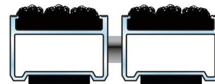
Pour les modèles concurrentiels au niveau du prix nous proposons un profilé aluminium garni en sous face d'une bande de mousse-polyéthylène. Cette solution est adoptée par la plupart des concurrents sur le marché. Notre gamme STANDARD comprend les modèles Top Clean CLASSIC et ROBUST.
